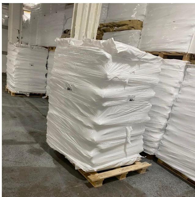
Figur 4. Palle med 50 kg blokker emballert med Nordic ECO Bag der blokkene med fisk delvis har sklidd av trepallen ved dårlig vær, som følge av lav friksjon mellom ECO Bag og palle.
