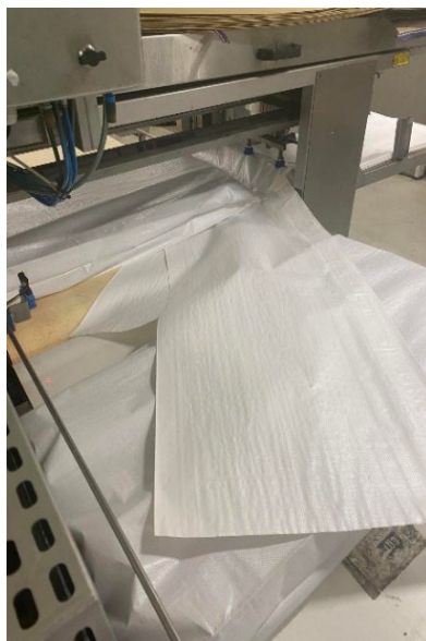
Figur 3. Testing av første prototype. Feil/stopp på pakkelinje som følge av feil i pakking (brett i hjørnet) av ECO Bag fra leverandør. (Foto: Nikolai Giske, Atlantic Viking).
